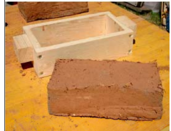
Esempio di compattazione di mattoni in terra cruda e paglia,
