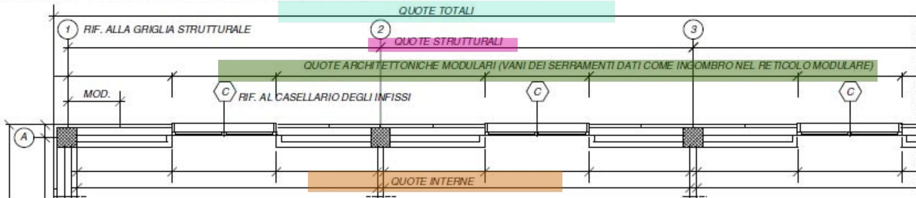
Sistemi di quotature delle piante – edificio in **MURATURA PORTANTE**
