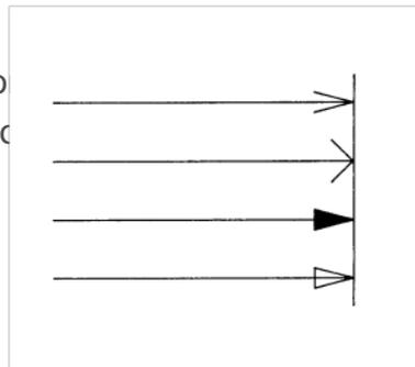
Le frecce, di norma, vanno poste internamente alle linee di riferimento. È possibile disporle esternamente quando richiesto per motivi di spazio. Per lo stesso motivo possibile sostituire le frecce con dei puntini.
