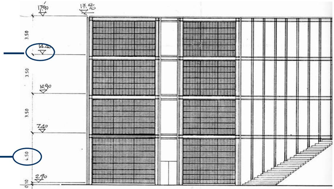
La **SEZIONE** è ottenuta con un piano sezionante verticale. Come nella pianta, anche nella sezione si disegnano sia le parti sezionate dal piano sia le parti retrostanti in proiezione.
