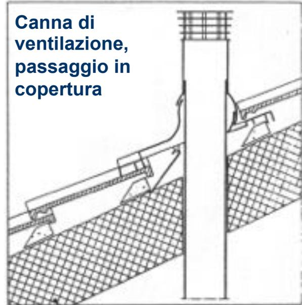
**Dettaglio del dispositivo di tenuta in corrispondenza del giunto**
