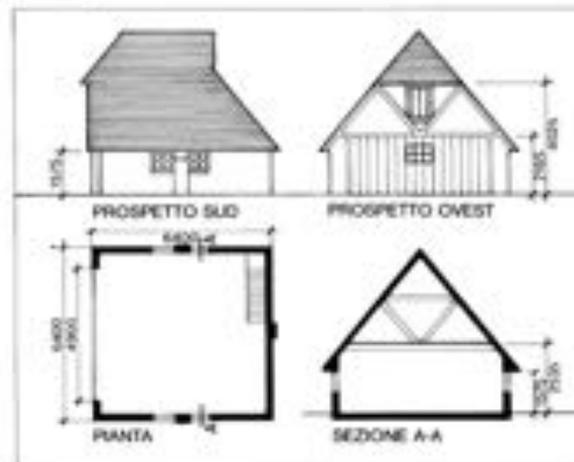
La scala e le proporzioni devono rimanere costanti in tutta la sequenza ortografica. Ciò permette di trasferire le informazioni relative allo spazio e alle dimensioni da un disegno all'altro. Le informazioni sono così fornite contemporaneamente, proponendo una immagine completa anche delle forme architettoniche più complicate.
