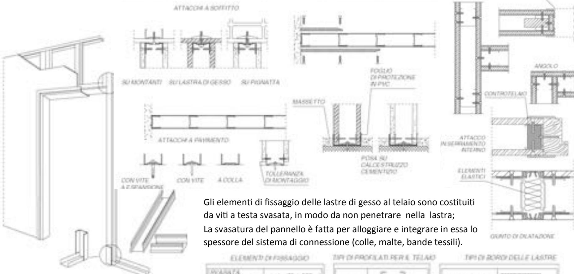
Gli elementi di fissaggio delle lastre di gesso al telaio sono costituiti da viti a testa svasata, in modo da non penetrare nella lastra; La svasatura del pannello è fatta per alloggiare e integrare in essa lo spessore del sistema di connessione (colle, malte, bande tessili).
