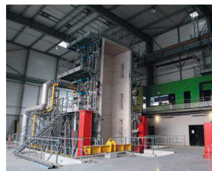
CSTB, Centre Scientifique et Technique du Bâtiment, Parigi. Laboratorio Vulcain. Le grandi attrezzature per la ricerca sulla resistenza al fuoco delle strutture innovative
