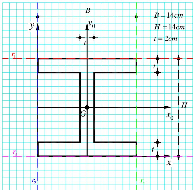
Applicando le formule prima richiamate, ricordando che nel caso in esame  $I_{x_0} \equiv I_{\xi}$  ed  $I_{y_0} \equiv I_{\eta}$ , si possono quindi calcolare le coordinate dei vertici  $R_1$ ,  $R_2$ ,  $R_3$  e  $R_4$ , antipoli rispettivamente delle rette  $r_1$ ,  $r_2$ ,  $r_3$  e  $r_4$ . Si calcola:
