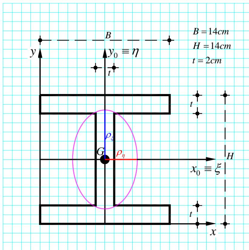
L'individuazione dell'ellisse, noti i semiassi  $\rho_\xi \equiv \rho_{x_0}$  e  $\rho_\eta \equiv \rho_{y_0}$ , può condursi anche sfruttando una semplice costruzione grafica di seguito illustrata e riportata schematicamente nella Figura seguente.
