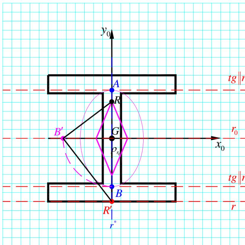
Ripetendo la costruzione per le altre 3 tangenti alla figura resa convessa si individua in modo completo il nocciolo centrale di inerzia della sezione.
