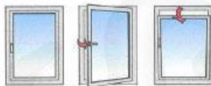
Finestre ad un anta con opzione anta ribalta
